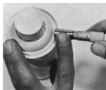
N° 207 midiendo la costura de la soldadura de la lata aerosol.
