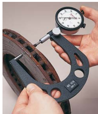
Midiendo la profundidad de la ranura del rotor del disco de freno con el n° 1016.
