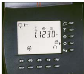
Mostrador grande, fácil de ver y interpretar, en el ejemplo muestra el diámetro de un agujero.
