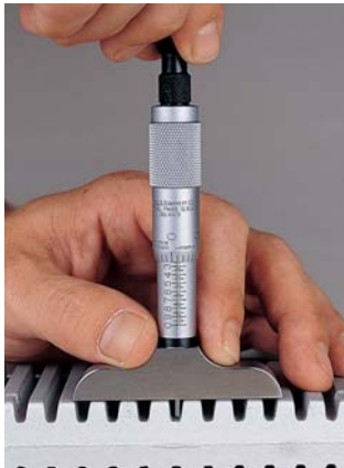
Midiendo la profundidad de una ranura estrecha.
