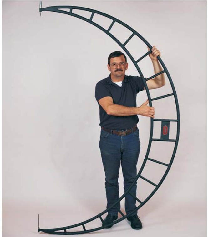
Starrett puede fabricar micrómetros extra grandes, como este Especial N° 724, de construcción tubular, rango de 1800-1950mm (72"-78"), con puntas intercambiables.
