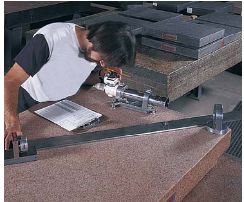
Inspeccionando un nivelador de granito con un autocolimador.
