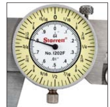
Esfera con lectura fraccionada de pulgada del modelo 1202-6F.
