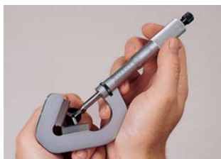
Midiendo diámetro externo de escariador con 3 cortes.
