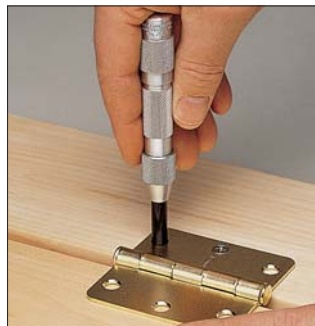
Esta herramienta localiza automáticamente y centra agujeros escariados de guía para tornillos a través de bisagras, sujetadores, pestillos, etc.
