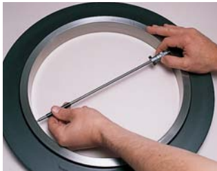
Midiendo el diámetro interno con micrómetro y varillas.
