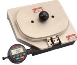
Matriz en la posición de ajuste del cero en el reloj comparador.
