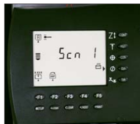
Mostrador LCD con registro de escaneo único para visualización fácil de la posición del palpador.
