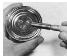
N° 208 midiendo el espesor de la costura de lata común.
