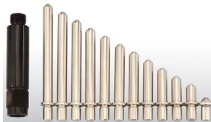
Arriba están las puntas de contacto, la extensión de 50mm y suministrados con el cabezal de 50-160mm.
