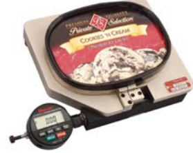
Tapa de recipiente en la posición de medición.
