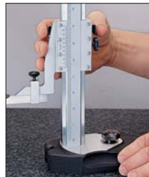
Dispositivo de ajuste rápido, permite acercar la parte corredera a una medida y posicionarla con precisión, a través del botón de ajuste fino.
