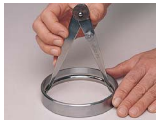
Verificando ranura interna.
