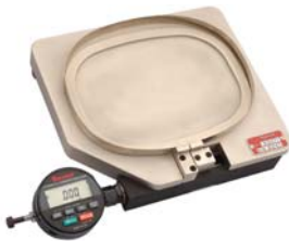
Cinta de metal para la medición de diámetros internos en recipiente de 5 galones.
