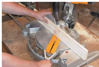
2. Ajuste la sierra al ángulo que la flecha roja indica en la escala roja .
