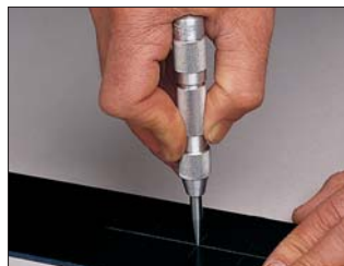
Marca centros con precisión y facilidad, usando una única mano.
