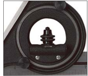
En detalle: Burbuja de nivel ubicada en la parte trasera del transportador.
