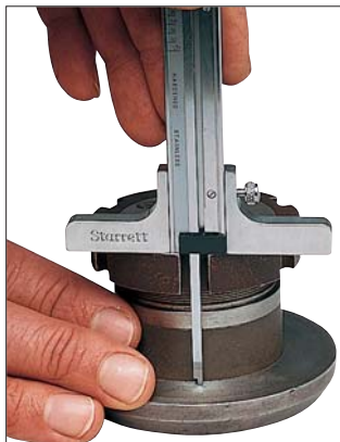
Haciendo medición de profundidad con calibre y dispositivo PT22431.
