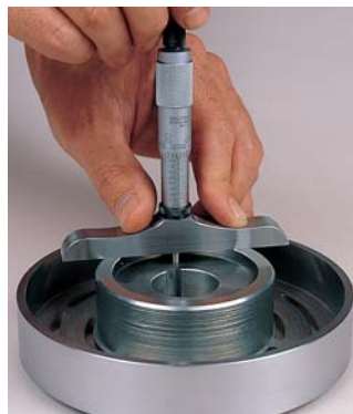
Midiendo la profundidad de relieve con el Micrómetro N° 445AZ-3RL.
