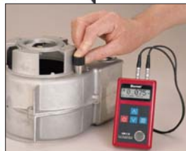
Medición de espesor de una pieza, difícilmente realizable con instrumentos convencionales.
