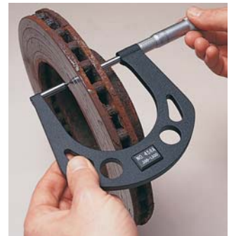
Midiendo la profundidad de la ranura de desgaste de un disco de freno con 458AXRS.
