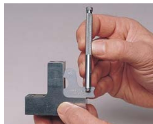
Verificando radio con plantilla y mango.
