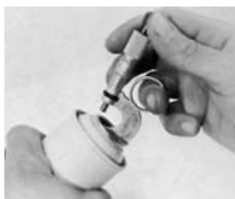
Nº 209 midiendo el espesor de la abertura de la lata de aerosol.
