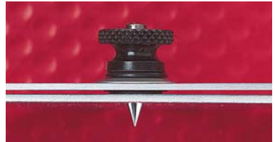
Vista lateral del transportador con la punta aguda en el lugar.
