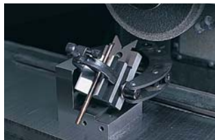
Rectificando un ángulo en una pieza cilíndrica.
