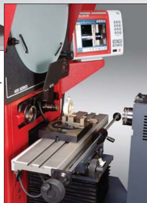
Arriba y a la derecha: el nuevo, perfeccionado Adaptador para Cámara de Video OV 2 utiliza la capacidad gráfica de la pantalla del Quadra-Chek 300.
