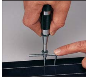
Localizando puntos equidistantes con Punzón Automático N° 18B y Accesorio Espaciador N° 18SB.
