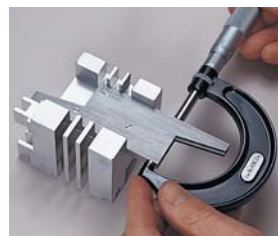
Arriba: Juego N° S154LZ con el N° 154E en primer plano. A la derecha: verificando la medida interna de un canal con bloque paralelo y micrómetro de exteriores.
