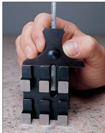
A la derecha: Midiendo la profundidad de un agujero ciego.
