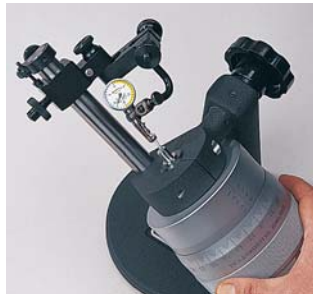
El Reloj palpador se mantiene en la posición a través de un soporte.
