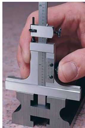
A la izquierda, modelo de 6"; a la derecha, midiendo profundidad de ranura.
