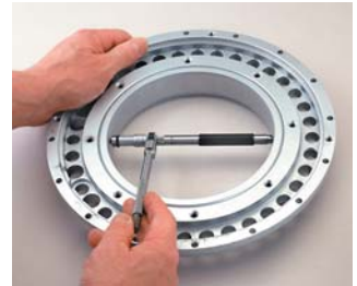
(Arriba) N° 823AZ 1.1/2-8" con cabeza, extensiones, mango y llaves. A la derecha: midiendo diámetro interno con el práctico mango acoplado al micrómetro.
