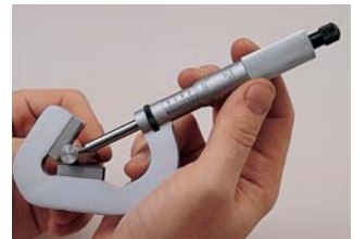
Verificando "ovalización" de la pieza rectificada en "centerless".
