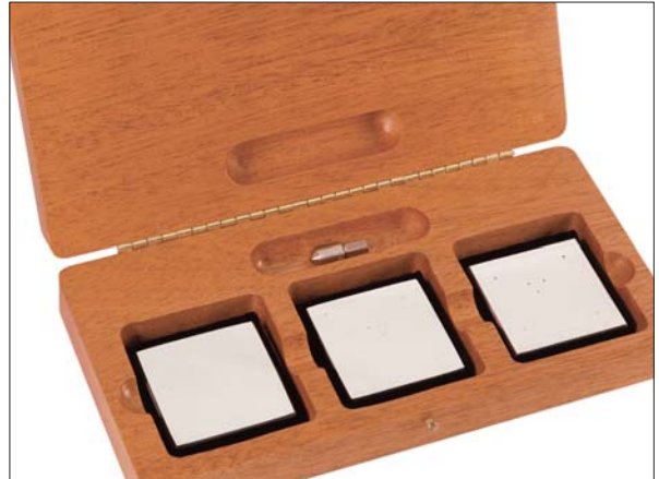
Kit de calibración PT05272 con 3 patrones Master HRC.
