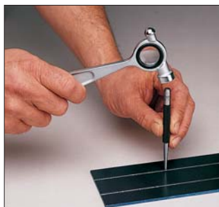
Localizando centros de agujeros en una pieza con Punzón Puntiagudo N° 816A y Martillo de Matricero N° 815.
