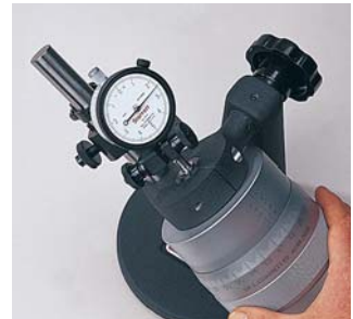
Calibrando un reloj comparador AGD.
