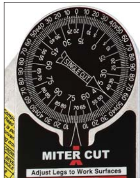
Arriba: Corte de Inglete y lecturas de corte único (ver #1y #2, izquierda).
