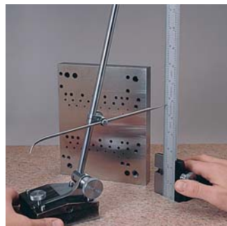
Transportando medidas con un gramil Starrett, usado en conjunto con regla y soporte.
