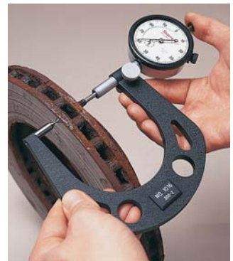
Midiendo la profundidad de la ranura del disco de freno con el n° 1016.
