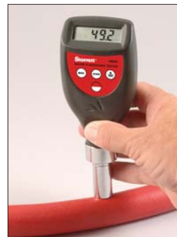
Verificando deterioro de anillo de goma o-ring.
