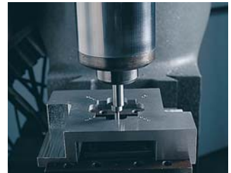
Localizando el centro con el N° 827MA.
