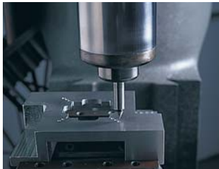
N° 827B localizando la arista de una pieza.
