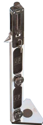
“Construcción” de una matriz de precisión con bloques patrón.
