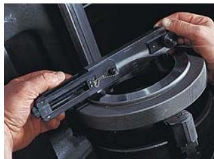
Calibrador usado para verificar dimensión interna de anillo liso aun sujeto a la rectificadora.
